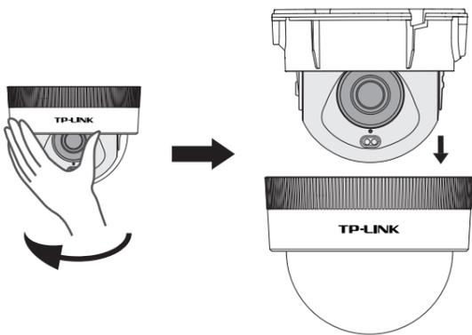
**2 设备安装** (\*安装时请将扬声器旁的拆装标识放置可见位置，便于安装球罩。)
